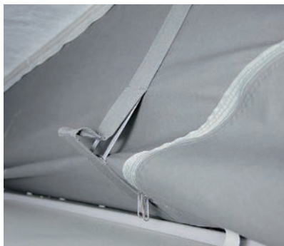
Einklappmechanismus bei SCAcomfort und SCAhigh, der den Stoffbalg beim Schließen der Dachschalen nach innen zieht
