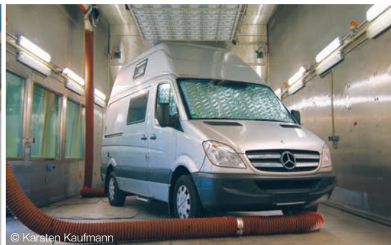
Fahrzeug mit einem SCA-Hochdach in der Kältekammer
