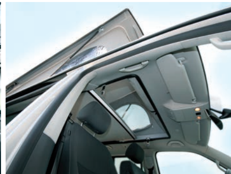
In das aufgestellte Dachbett gelangt man durch die Durchstiegsöffnung über den Vordersitzen. Im Bild zu sehen ist die aufgerollte Abdeckung aus Kunstleder.
