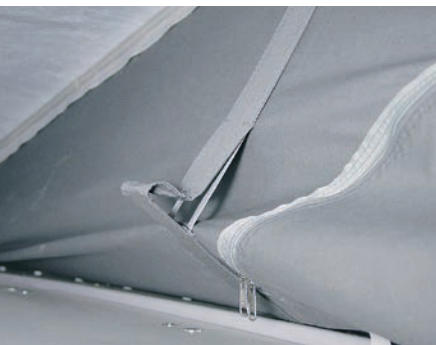
Mechanizm składania mieszka materiałowego
