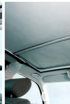
Tapicerowane przykrycie ze sztucznej skóry, które przy zamkniętym dachu przykrywa złożony mieszek materiałowy.
