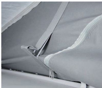
Mechanizm składania w SCAcomfort i SCAhigh, który pociąga mieszek materiałowy do wewnątrz podczas zamykania skorup dachowych
