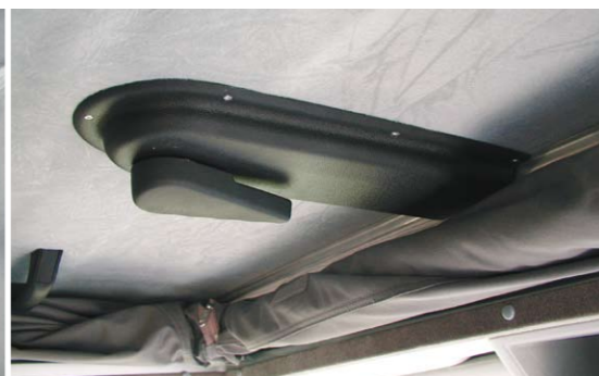
Verrouillage automatique par poignées
