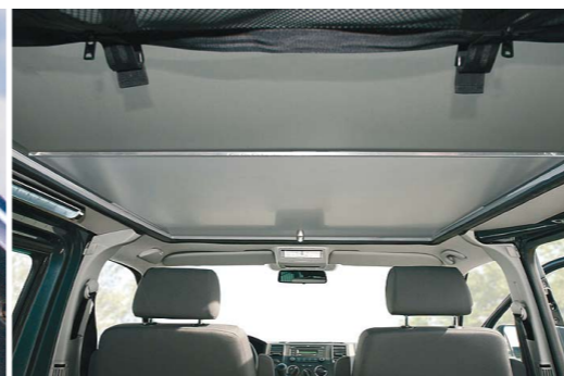
Panneau coulissant pour fermer la trappe
