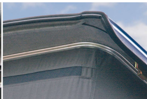
Fuelle de tela con burlete circular y rail de aluminio
