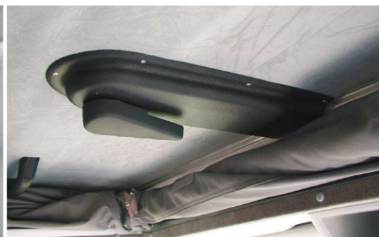
Cierre centralizado mediante cerraduras de resorte
