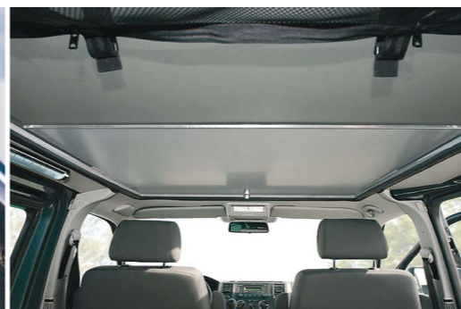
Trampilla deslizante para cerrar la abertura de acceso
