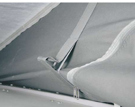
Mecanismo de plegado del fuelle de tela
