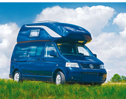
Alkoven-Hochdach auf VW T5, l. R.
