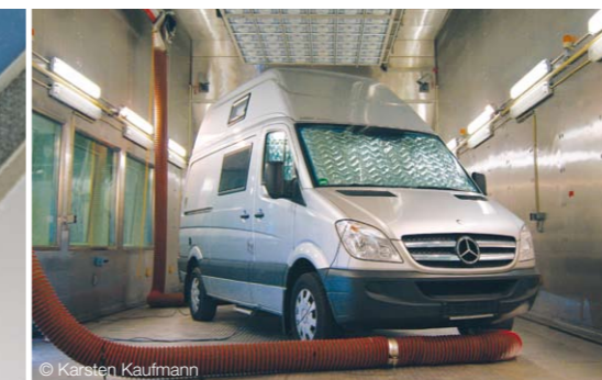
Mercedes Sprinter mit Hochdach SCA 472 in der Kältekammer
